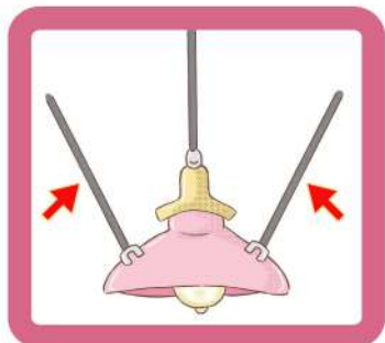
▲ 加強固定懸掛在天花板上的照明燈
