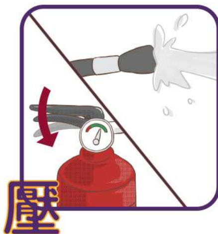
壓下手壓板，滅火器噴出
